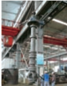
発電施設用ポンプ
